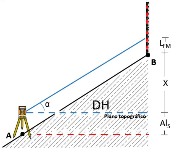
$Al_S$  – Altura do instrumento à superfície |  $L_{FM}$  – Leitura do Fio Médio
