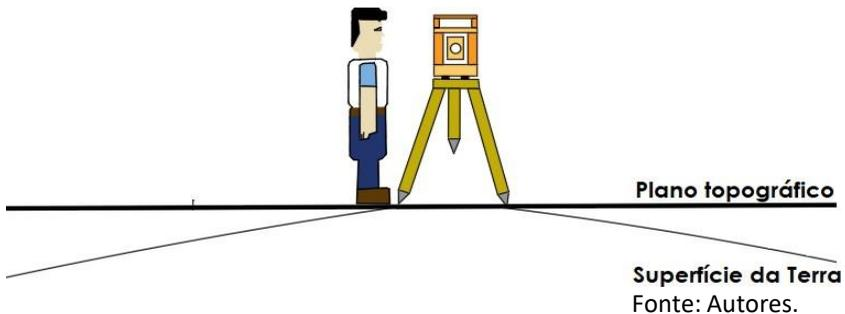
Figura 8 – Representação do erro de esfericidade obtido através do arco da terra e o plano topográfico.
