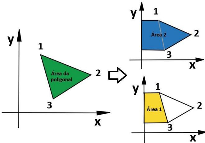
Onde, para se determinar a área do trapézio utiliza-se a fórmula de Gauss.
